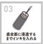
底全面に浸透する までインキを入れる
